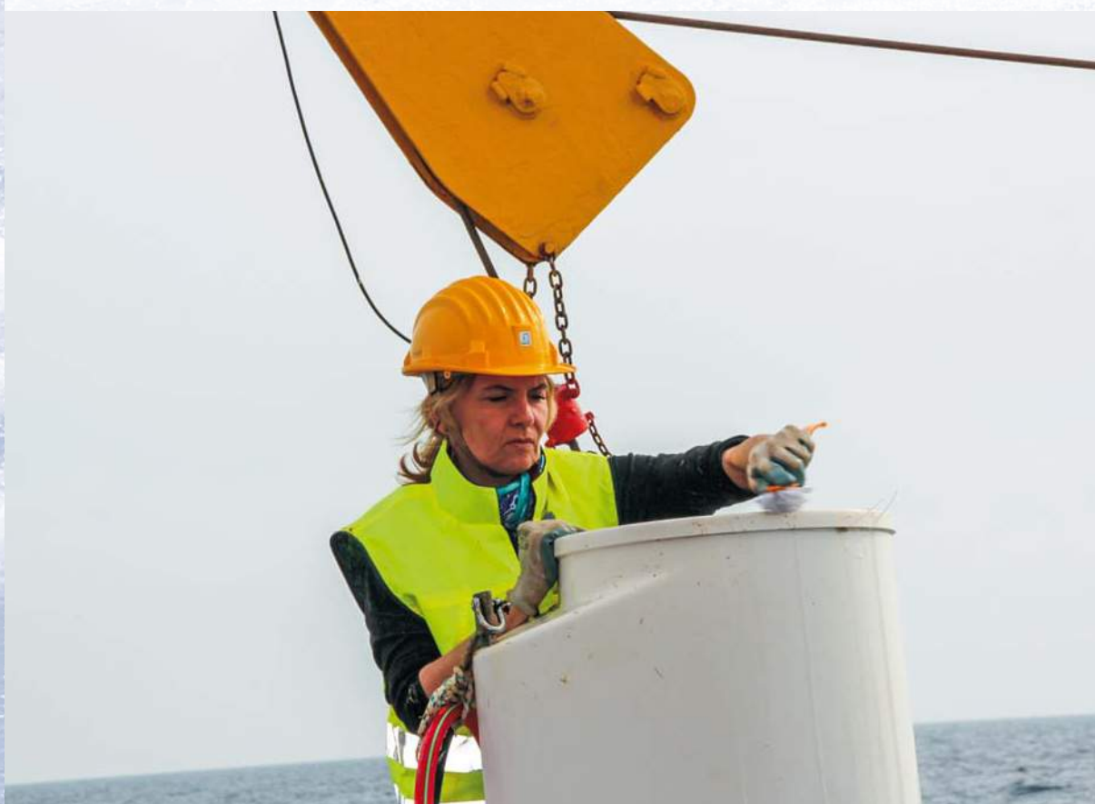
Mare Adriatico Meridionale. Preparazione di una trappola automatica per il campionamento di sedimento particellato a bordo della nave Minerva Uno - Foto L. Langone, 2016
