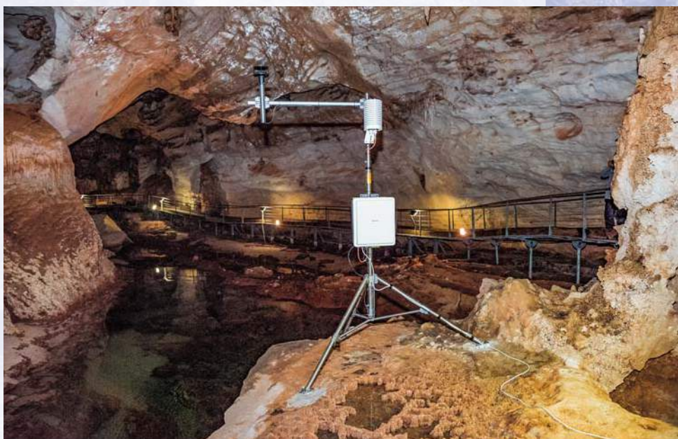
Dorgali, Nuoro, Italia. Interno della Grotta del Bue Marino, con i macchinari per la misurazione quali-quantitativa dei parametri fisico-atmosferici, in presenza e in assenza di frequentazione antropica – Foto G. Fasano, 2017
