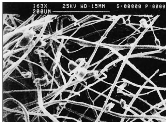
Figura 2.8: Immagine SEM di un insieme di fibre di seta. L'esposizione al calore produce deformazioni di tipo plastico che, nelle zone di frattura assumono un aspetto fungiforme [15]
