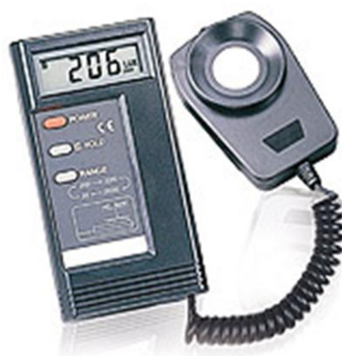
Figura 3.11 luxmetro utilizzato per le misurazioni d'illuminamento
