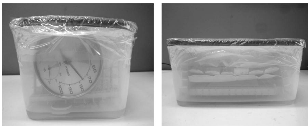
Figura 3.14 Contenitore per cicli termo igrometrici con termo igrometro e soluzione satura sul fondo
